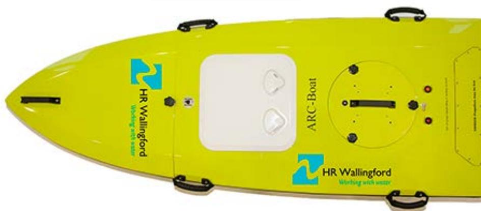
La ARC-Boat è un natante radiocomandato studiato appositamente per il trasporto di strumenti che consentono di eseguire, in modo facile e sicuro, misurazioni di portata in alveo, rilievi batimetrici, misure di concentrazione di solidi sospesi.
